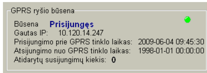
8 pav. GPRS ryšio būsenos indikacija
