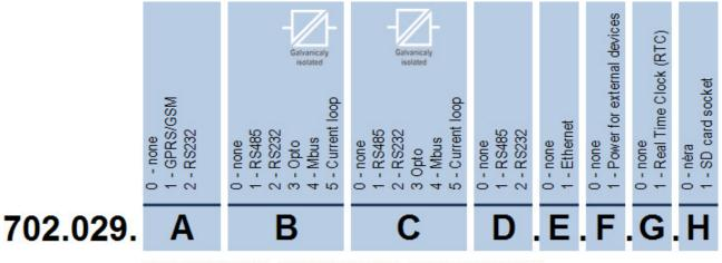
702.029.1432.1.0.1.0 - (GPRS, Mbus, Opto, RS232, Ethernet, RTC)
